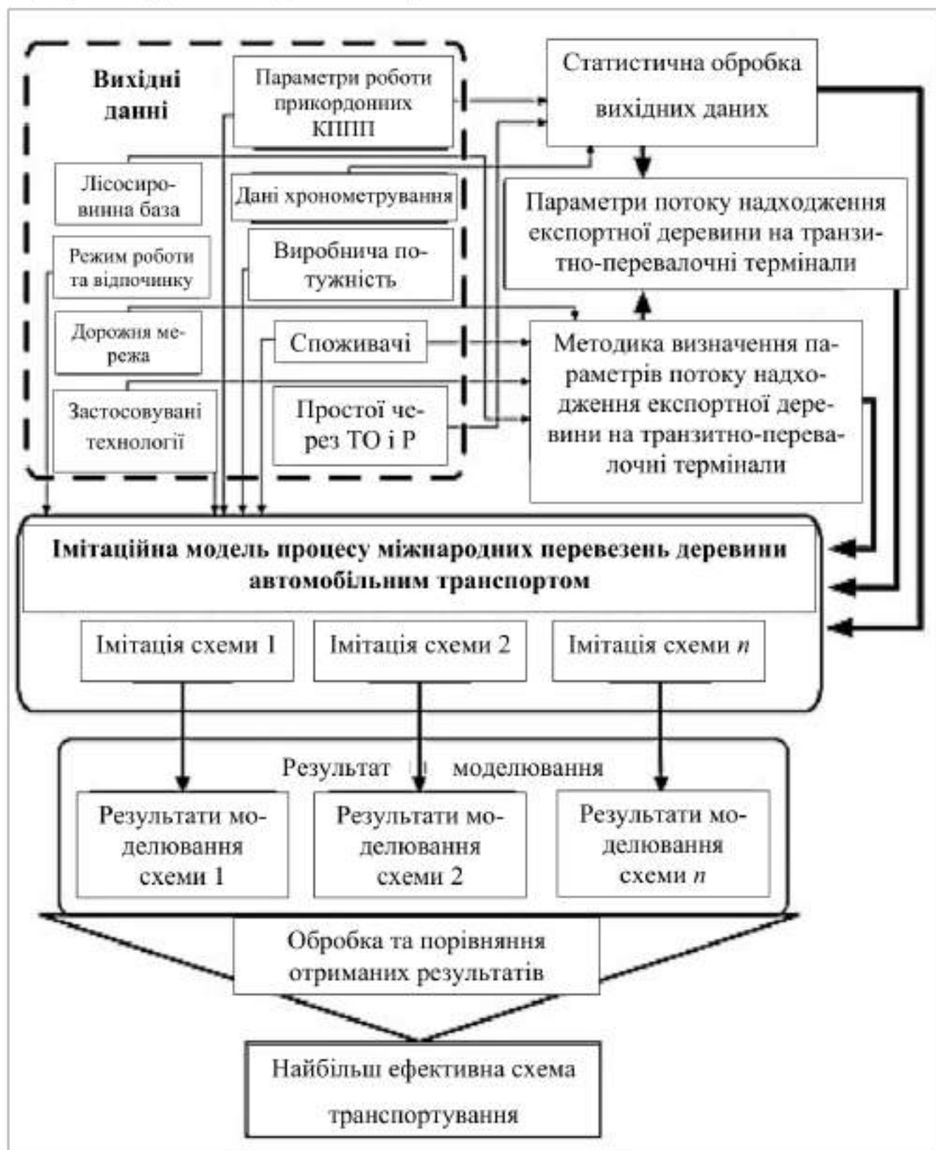
Рисунок 3.1 - Методика підтримки прийняття рішень щодо обґрунтування вибору схеми транспортно-технологічного процесу міжнародних перевезень деревини
