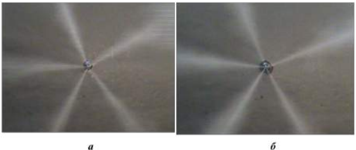
Рисунок 1.10. Фотографії струменів палива, отримані для серійного розпилювача (а) та досвідченого розпилювача за варіантом № 3 (б)
