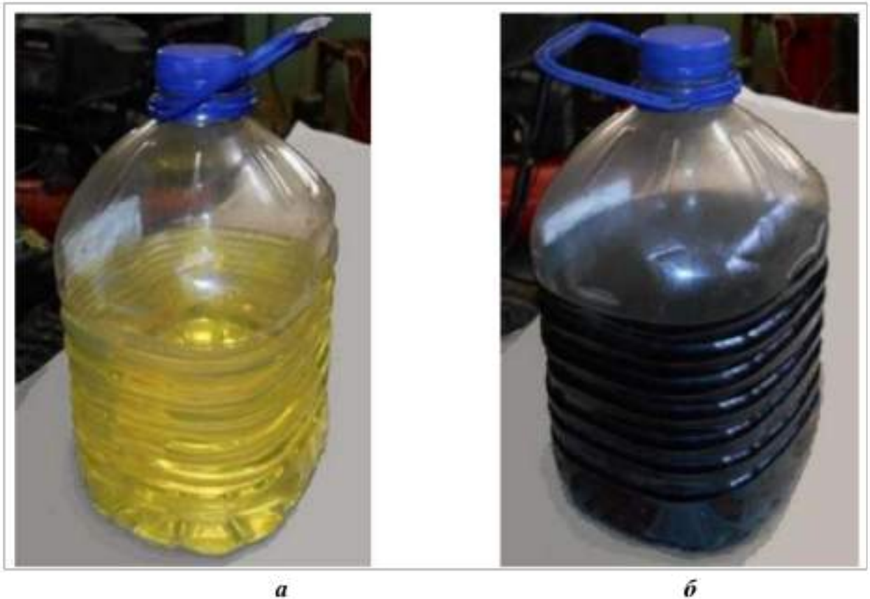
Рисунок 4.6. Вихідна нафтового ДП (а) та суміш нафтового ДП з ВНТ із вмістом останніх 250 мг/л, приготовленої в ультразвуковій ванні (б)
