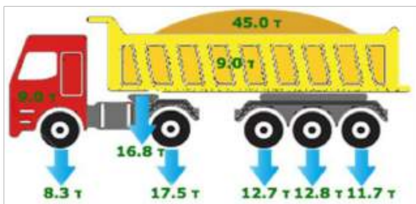
Рисунок 2.3 – Розподіл навантажень на вісь 5-вісного автопоїзда
