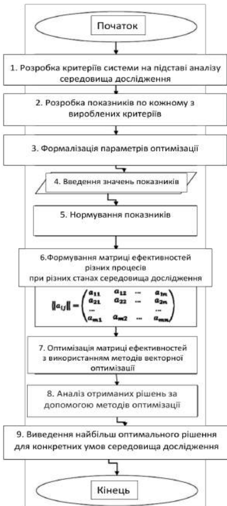
Рисунок 4.8 – Послідовність розв'язання оптимізаційного завдання щодо вибору можливих стратегій експлуатації великовантажних на АТЗ
