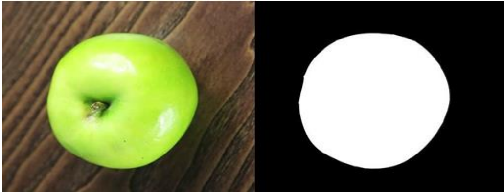
Рисунок 3.10 — Демонстрація роботи функції inRange()
