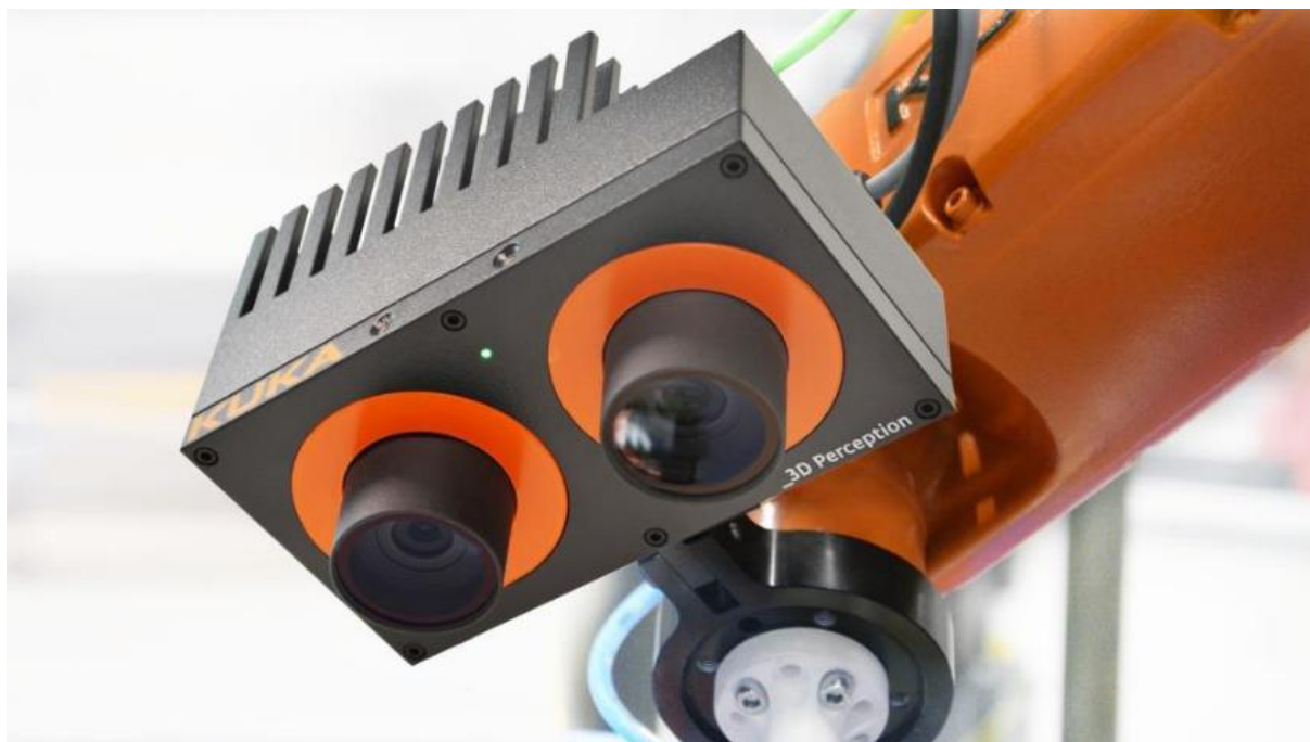
Рисунок 1.5 — Стереосенсор KUKA _3D Perception
