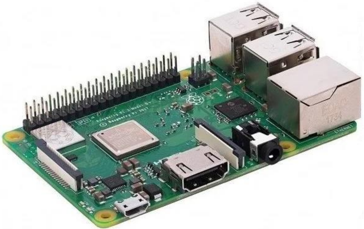
Рисунок 2.1 — Одноплатний комп'ютер Raspberry Pi 3 Model B
