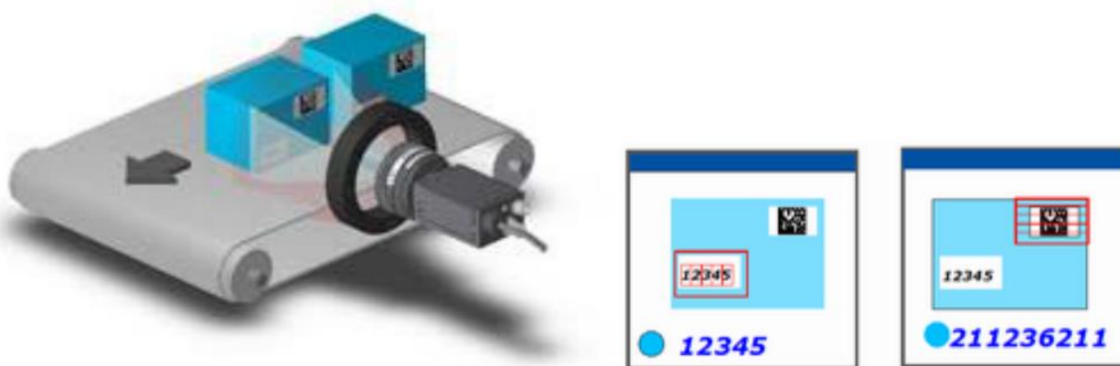
Рисунок 1.2 — Автоматичне зчитування 2D-коду та цифрового маркування
