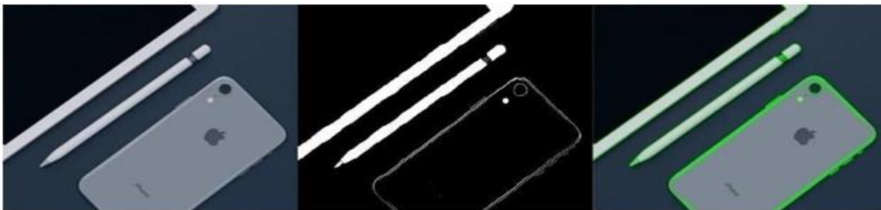
Рисунок 3.11 — Демонстрація роботи функцій findContours() та drawContours()
