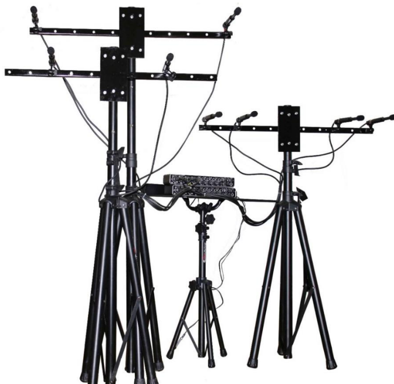
Рисунок 3.9 — Сійки з мiкрофонними решiтками 8-каналної 3-променевої АЦ-системи сканування акустичних сигналiв на мiсцевостi
