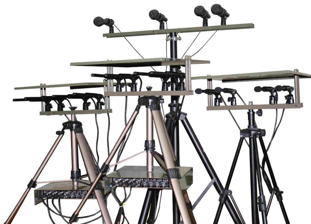
Рисунок 3.10 — Сійки з мiкрофонними решiтками 16-каналної 4-променевої АЦ-системи сканування акустичних сигналiв на мiсцевостi
