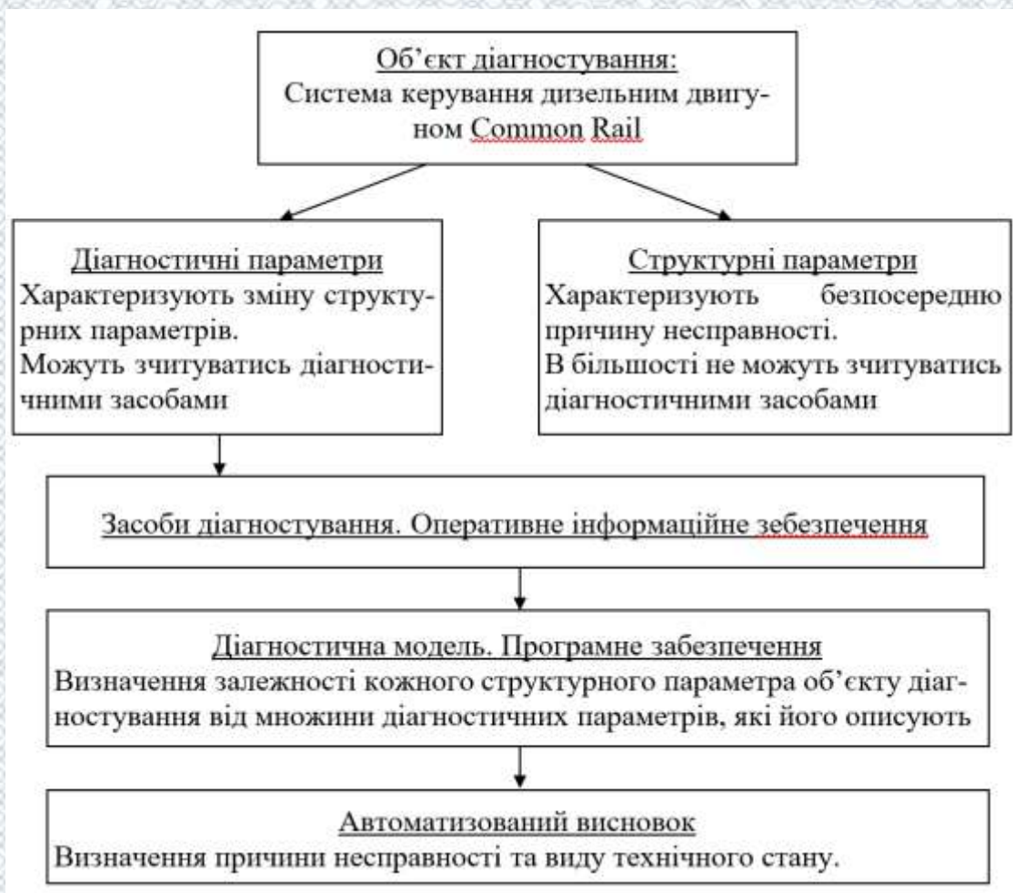
Рисунок 3.1 – Залежність між діагностичними і структурними параметрами
