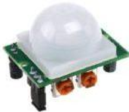
Рисунок 3.8 — Датчик руху HC-SR501.
