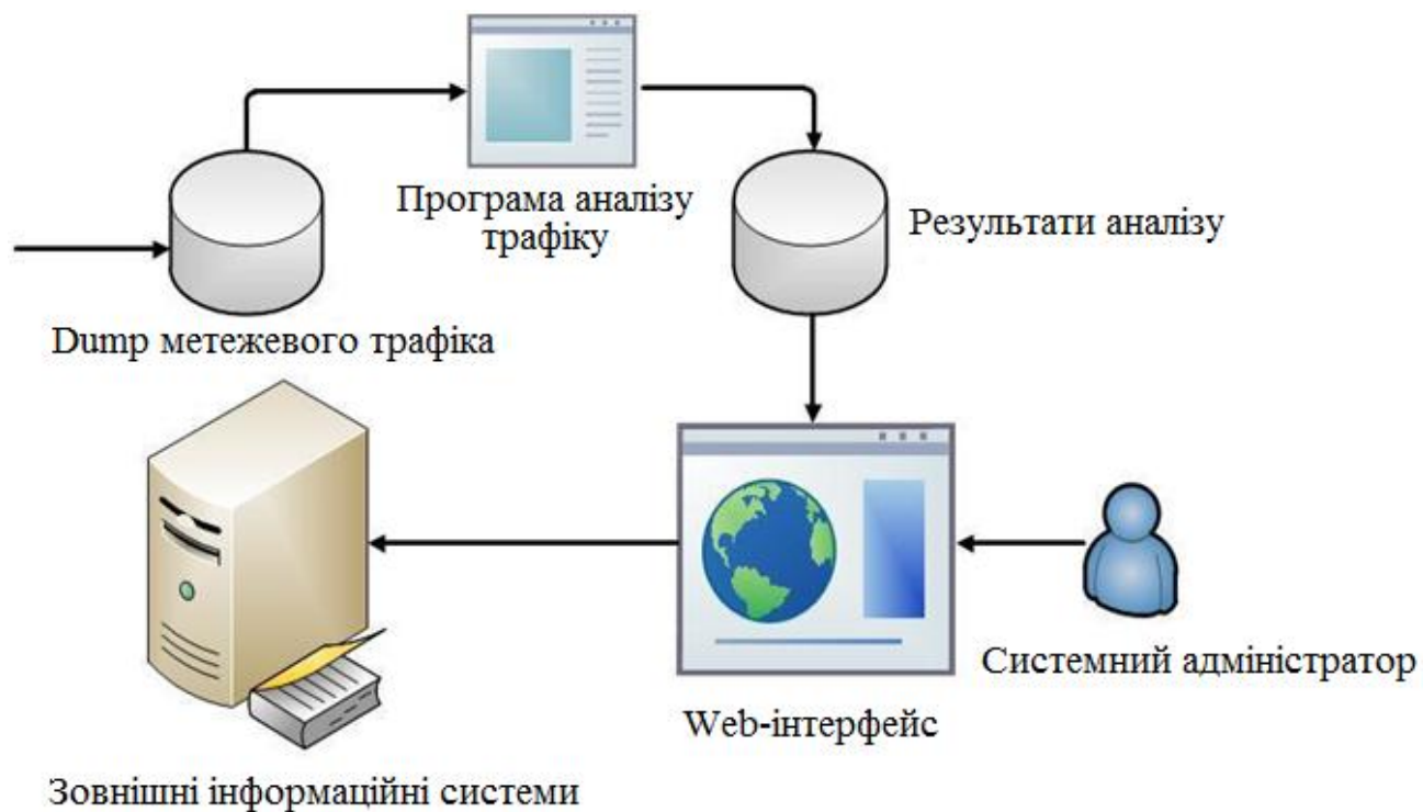
Рисунок В.1 — Структурна схема системи аналізу мережного трафіку
