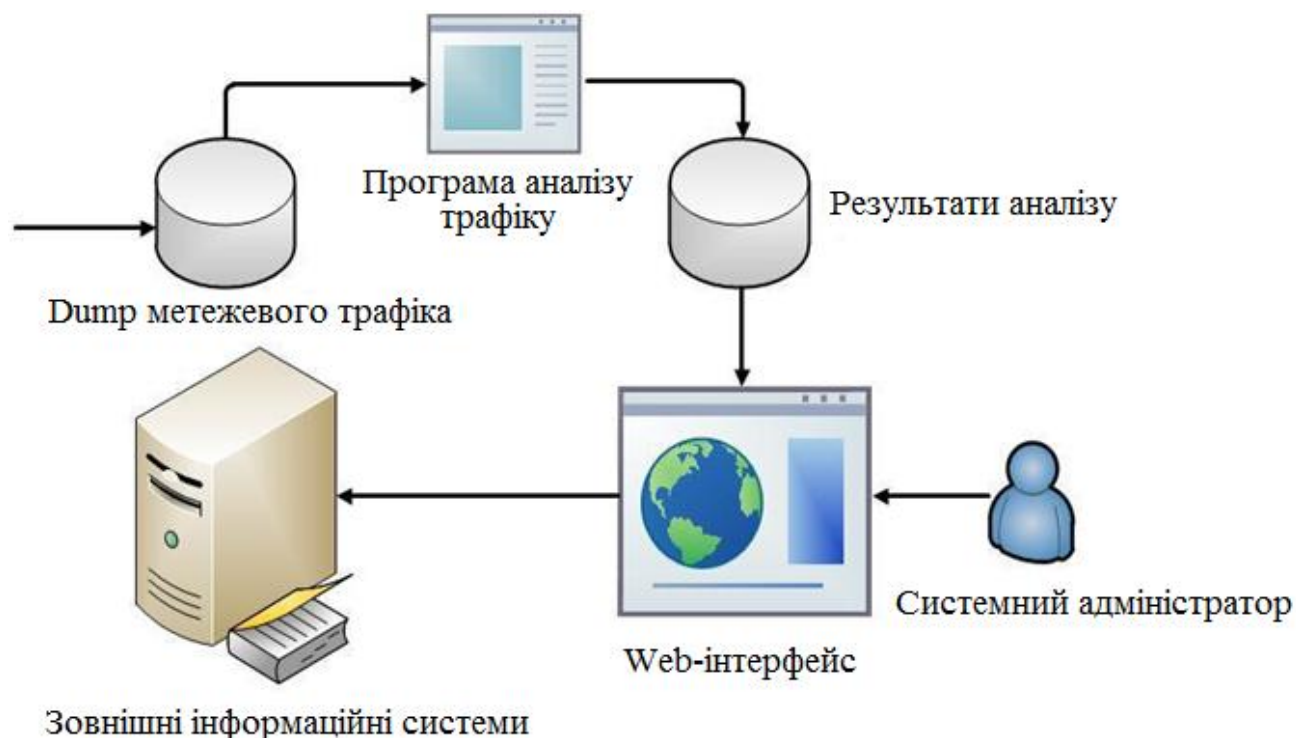
Рисунок 3.1 — Структурна схема системи аналізу мережного трафіку
