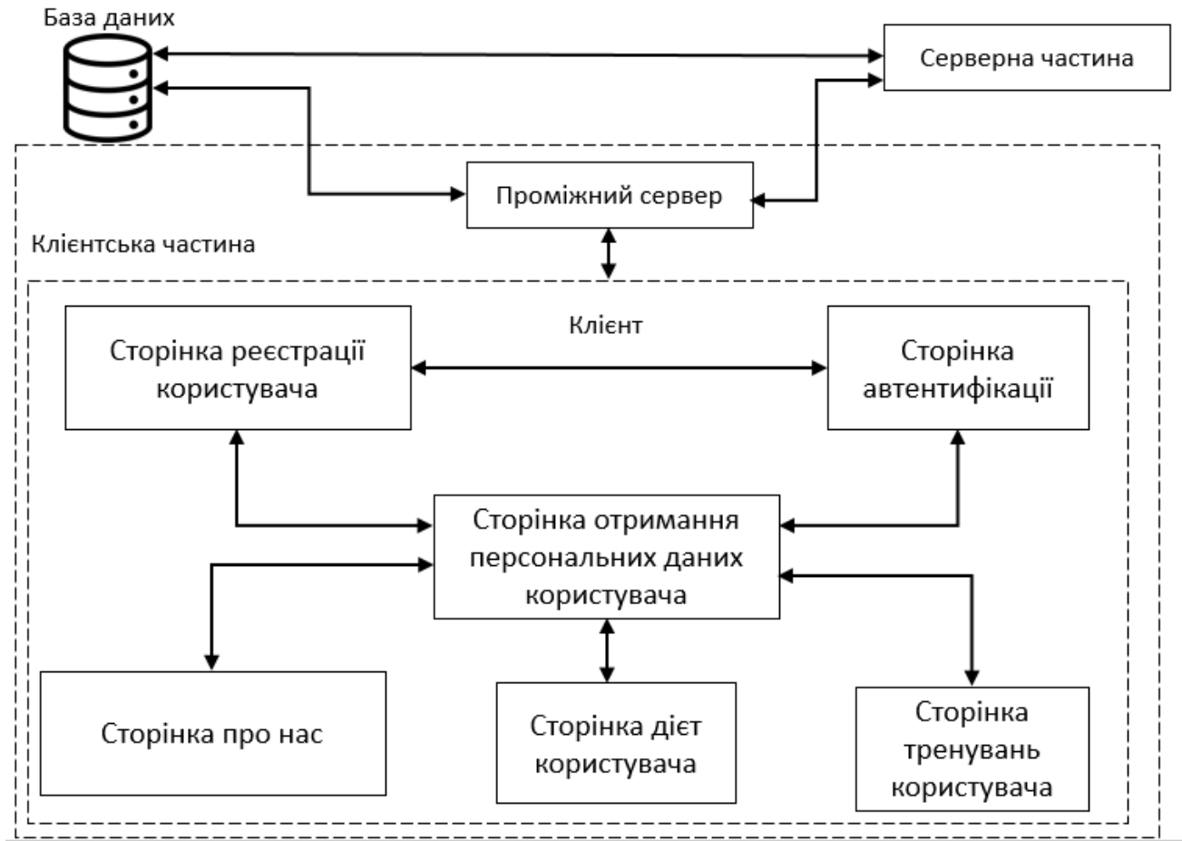
Рисунок Д.1 — Структурна схема клієнтської частини веб-застосунку
