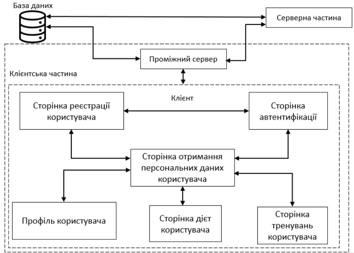
Рисунок 3.1 — Структурна схема клієнтської частини веб-застосунку
