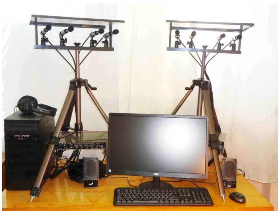
Рисунок В.1 — Зовнішній вигляд АЦ- системи портативного варіанту
