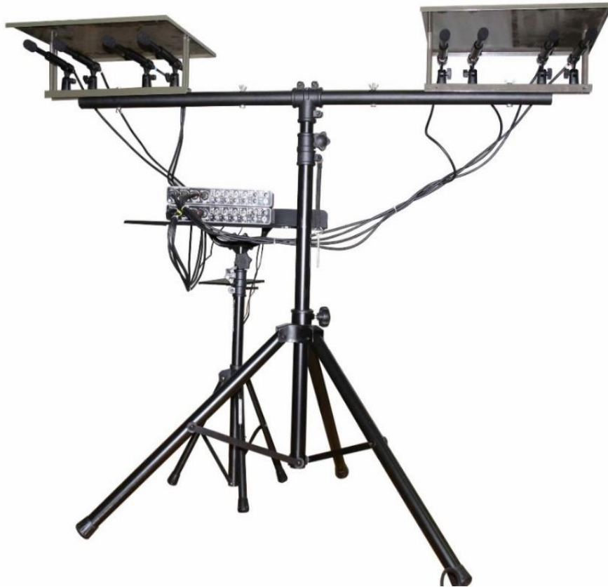
Рисунок 2.1 — Конструкція 8-канальної мікрофонної решітки з центральними проміжками
