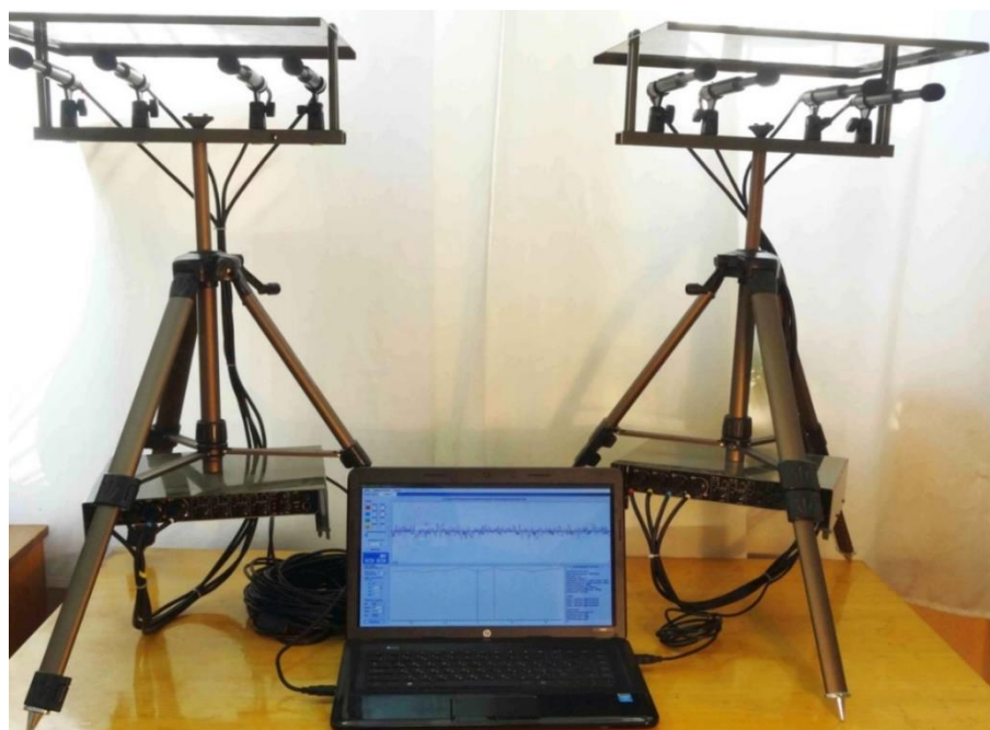
Рисунок В.1 — Зовнішній вигляд АЦ- системи портативного варіанту
