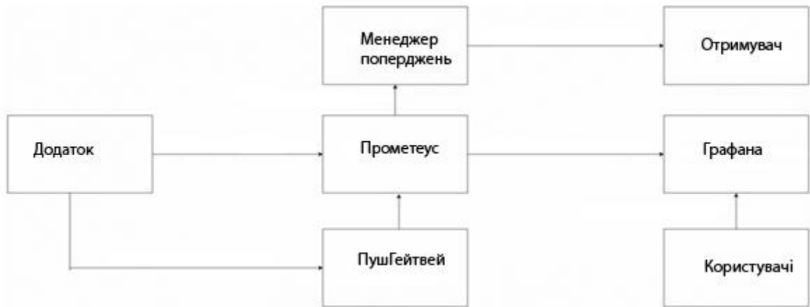
Рисунок 1.4 — Схема поєднання додатків та Prometheus
