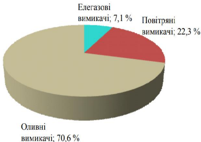
Рисунок 9.9 – Діаграма відмов високовольтних вимикачів
