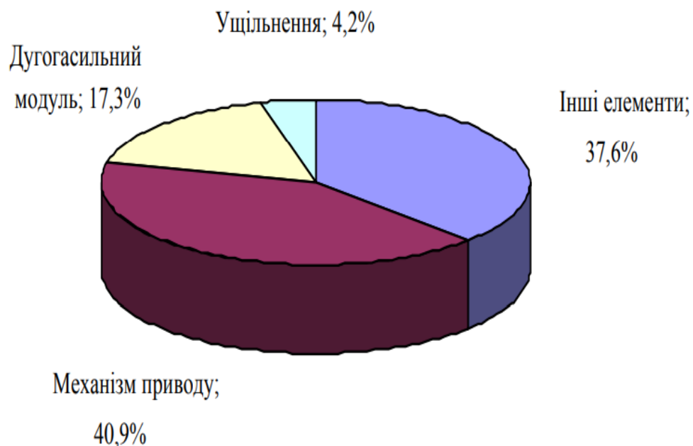
Рисунок 9.7 – Діаграма відмов елегазових вимикачів
