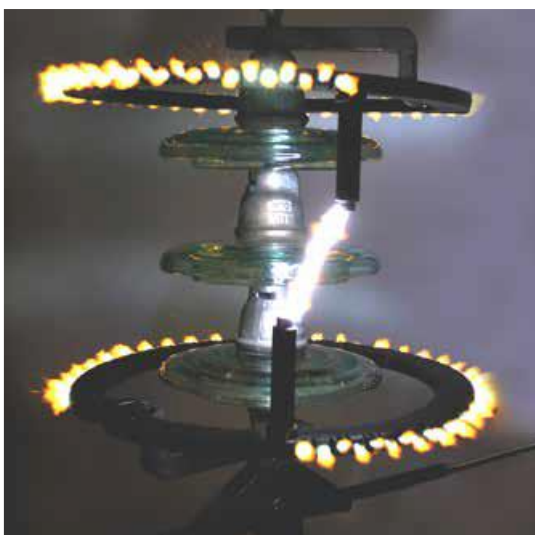
Рисунок 9.6 – Мультикамерна система (МКС) в роботі
