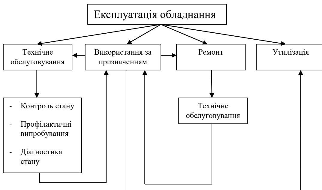
Рисунок 3.1 – Основні етапи експлуатації обладнання
