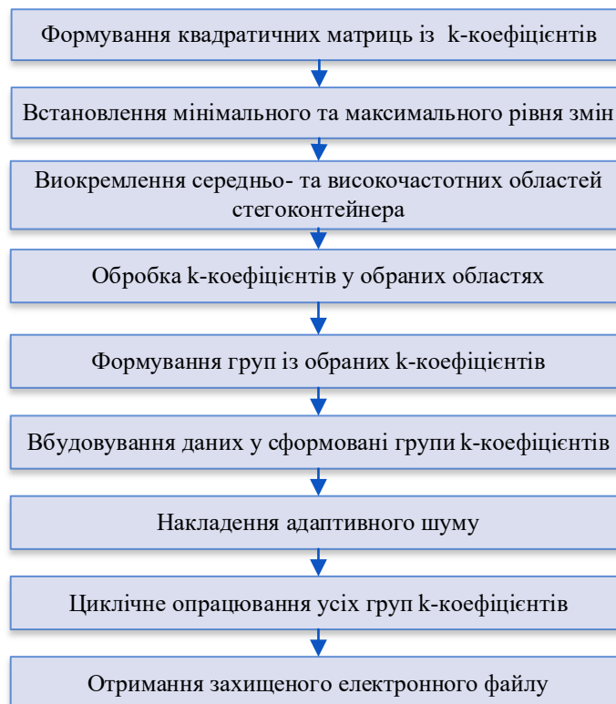
Рисунок 2.2 – Алгоритм вбудовування за вдосконаленим методом
