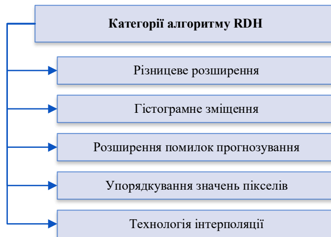
Рисунок 2.1 – Технології алгоритму оборотного приховування даних [31]
