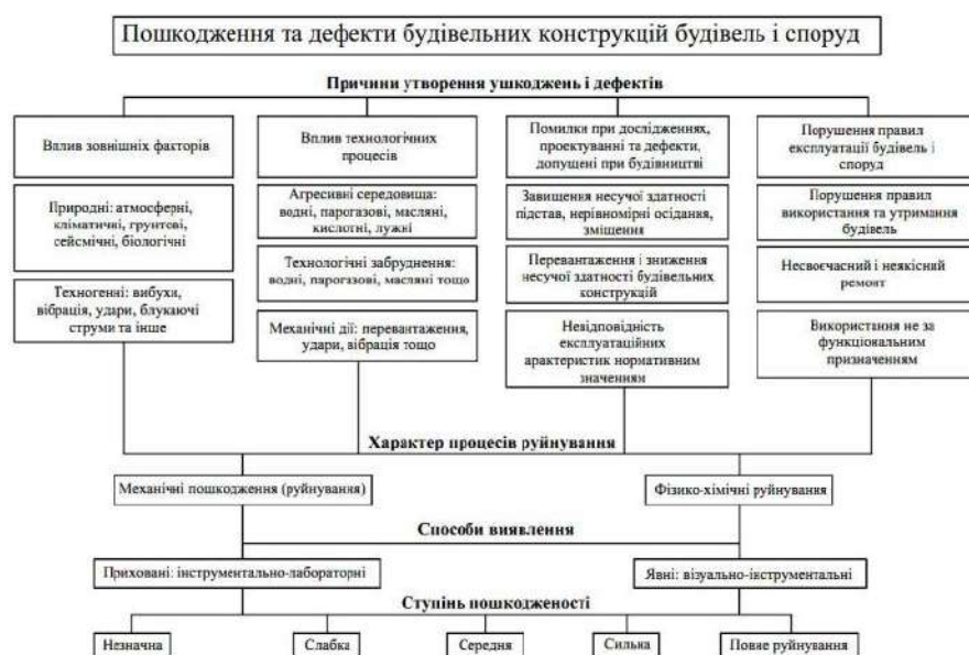
Рисунок 3.2 – Класифікація пошкоджень і дефектів будівель і споруд
