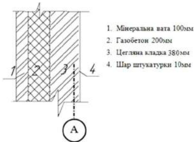
Рисунок 4.1.1 – Зовнішня стіна в розрізі
