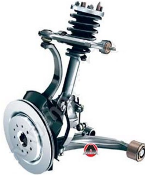
Рисунок 1.4 – Передня підвіска з амортизаторною стійкою на двох поперечних важелях
