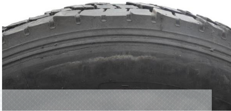
Рисунок 3.4 – Пилкоподібний знос шини
