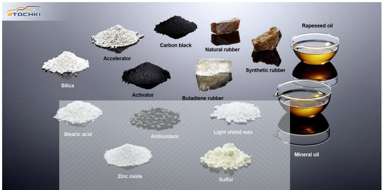
Рисунок 5.5 – Основні інгредієнти сучасної гумової суміші для виготовлення автомобільних еластичних шин
