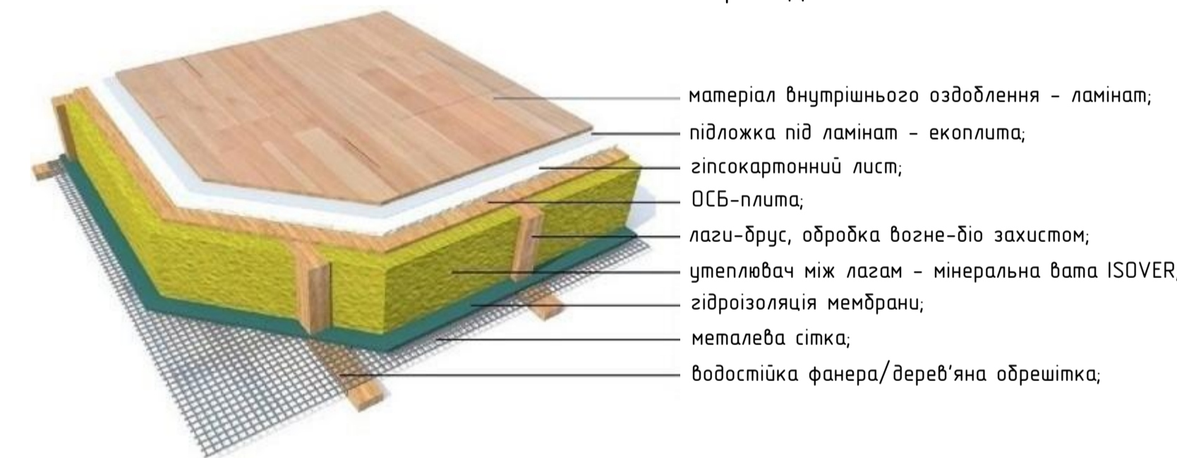
КОНСТРУКЦІЯ ПІДЛОГИ
