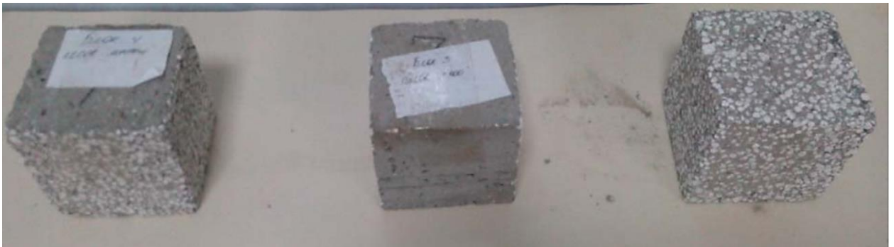
Рисунок 3.1 – ППСБ блоки розміром 100 \times 100 \times 100 мм
