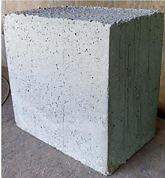
Рисунок 2.5 - Пінополістиролбетонний блок розміром 30×20×30 см
