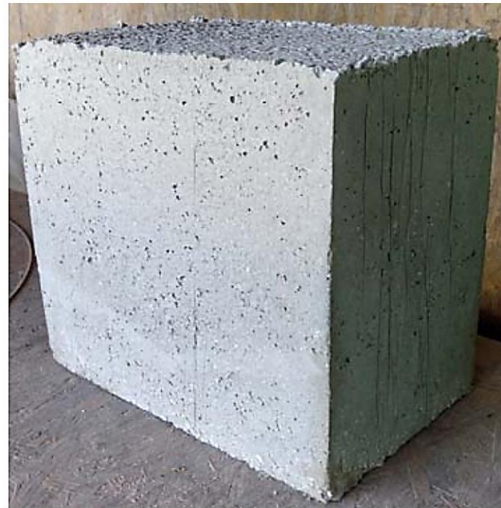
пінополістиролбетонний блок розміром 30×20×30 см
