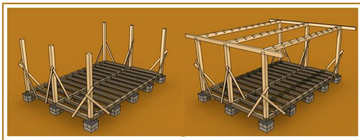
Рисунок 4.1 – Встановлення стійок каркасного будинку
