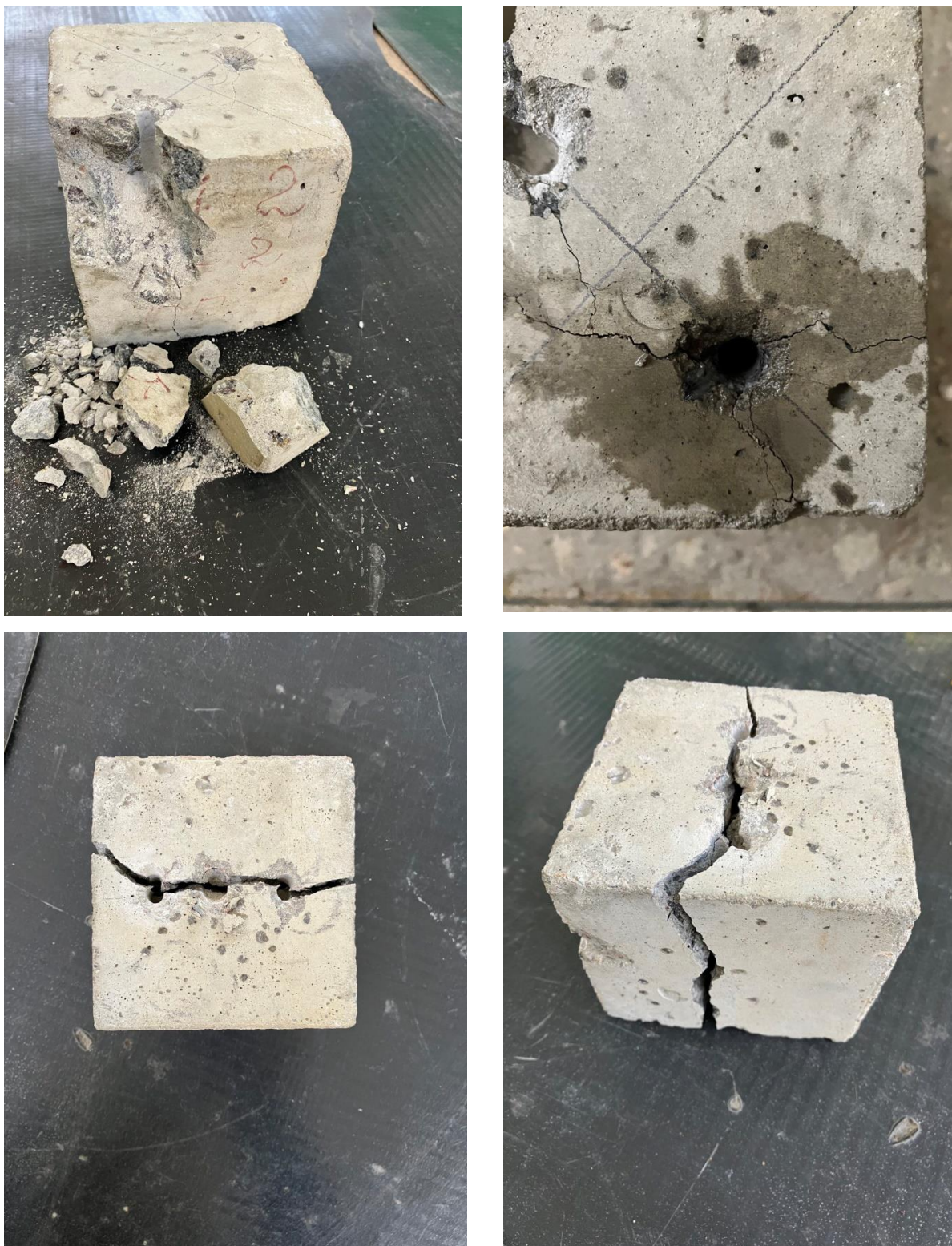
Рис. 23 – Характер руйнування зразків бетону
