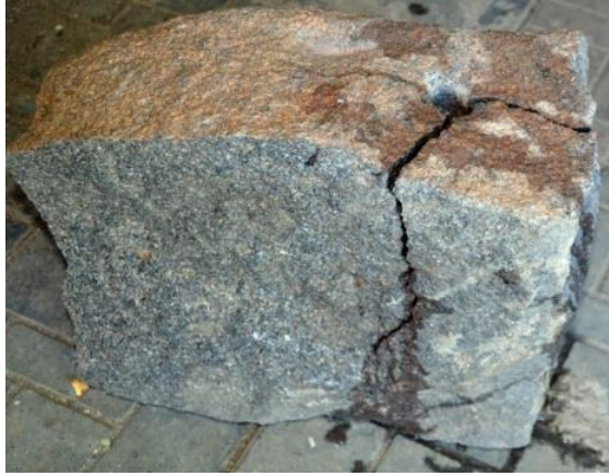
Рис. 8 – Руйнування з використанням електрогідравлічного ефекту
