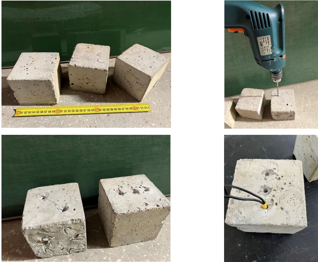
Рис. 22 – Підготовлені для руйнування зразки бетону
