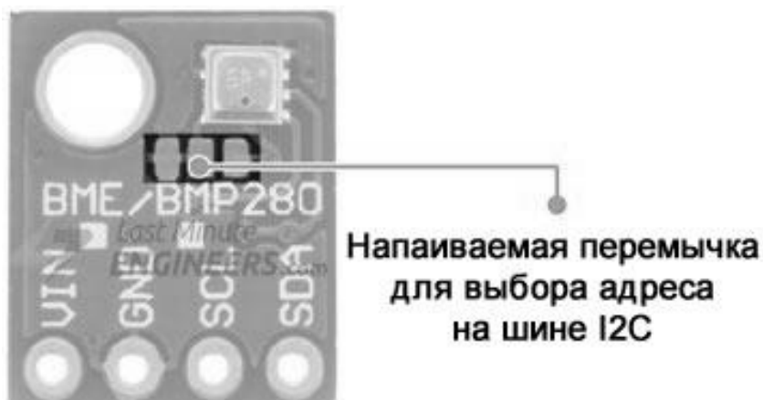
Рисунок 2.6 - Модуль BME280. Майданчики для пайки перемички для вибору адреси I2C
