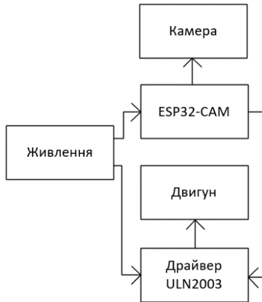
Рисунок 1 – Структурна схема IP камери відеонагляду на модулі ESP32-CAM
