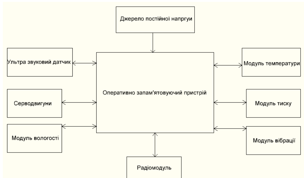
Рисунок 2.4 – Функціональна схема роботи системи
