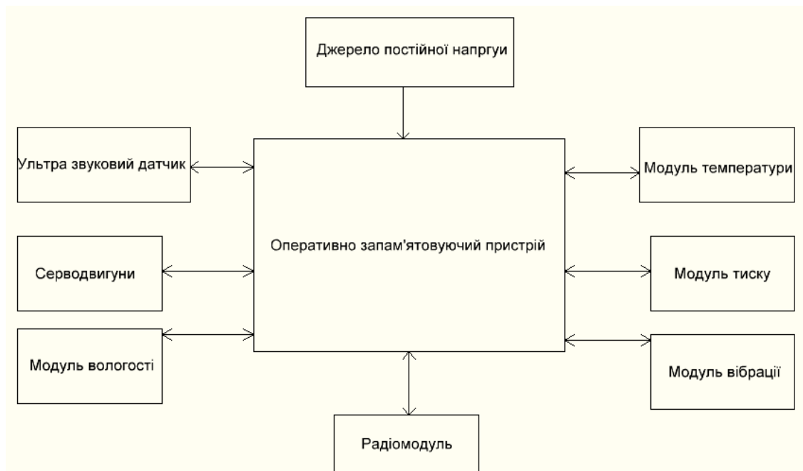
Рисунок 2 – Функціональна схема рухомої радіотехнічної системи контролю параметрів навколишнього середовища
