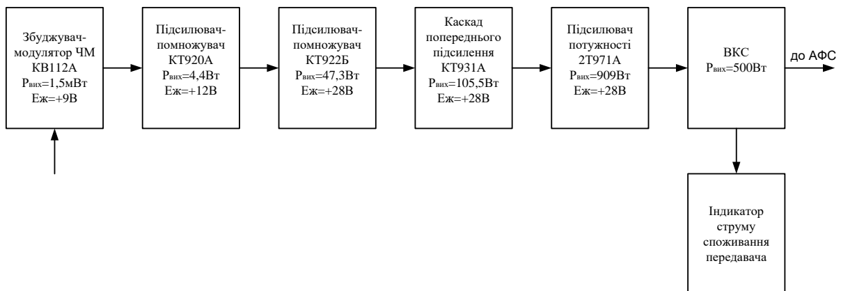
Рисунок 2.7 – Детальна структурна схема передавального блоку
