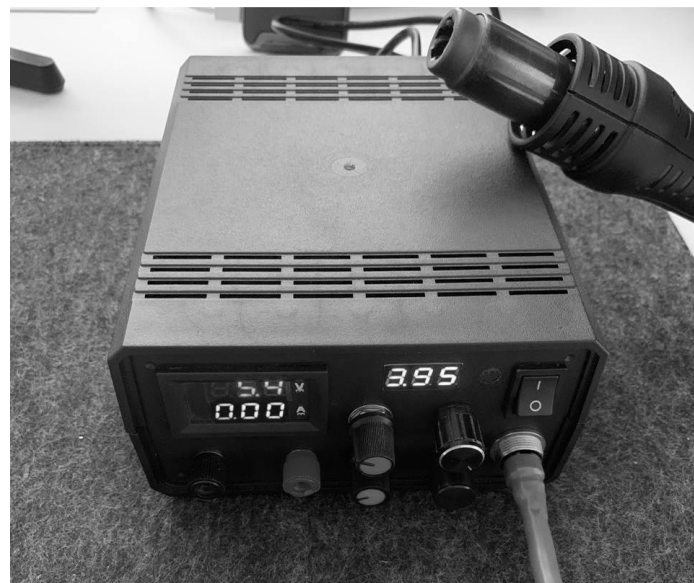
Рисунок 3.20 – Вимірювання споживаної потужності монтажного фену з лабораторним блоком живлення при навантаженні
