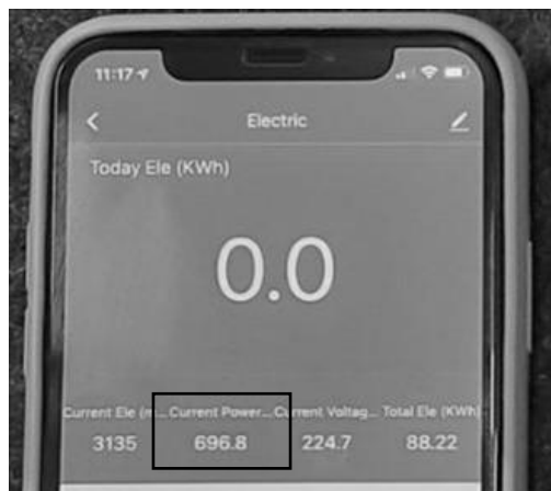
Рисунок 3.19 – Вимірювання споживаної потужності монтажного фену з спроектованим блоком керування
