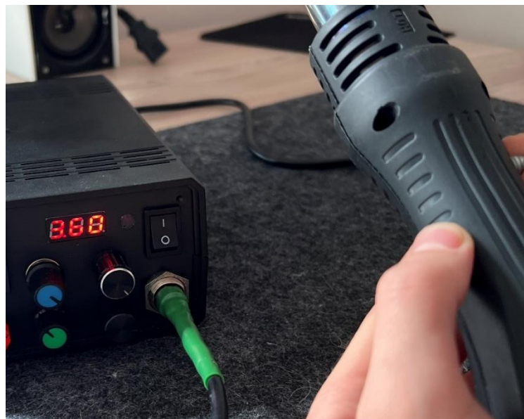
Рисунок 3.24 –Рробота датчика постановки на підставку (360°C)
