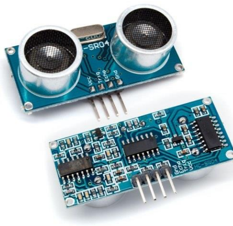
Рисунок 1.4 – Ультразвуковий датчик руху
