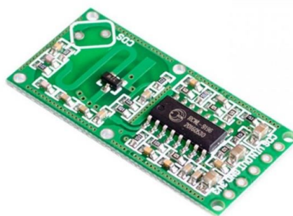
Рисунок 1.5 – Мікрохвильовий датчик руху
