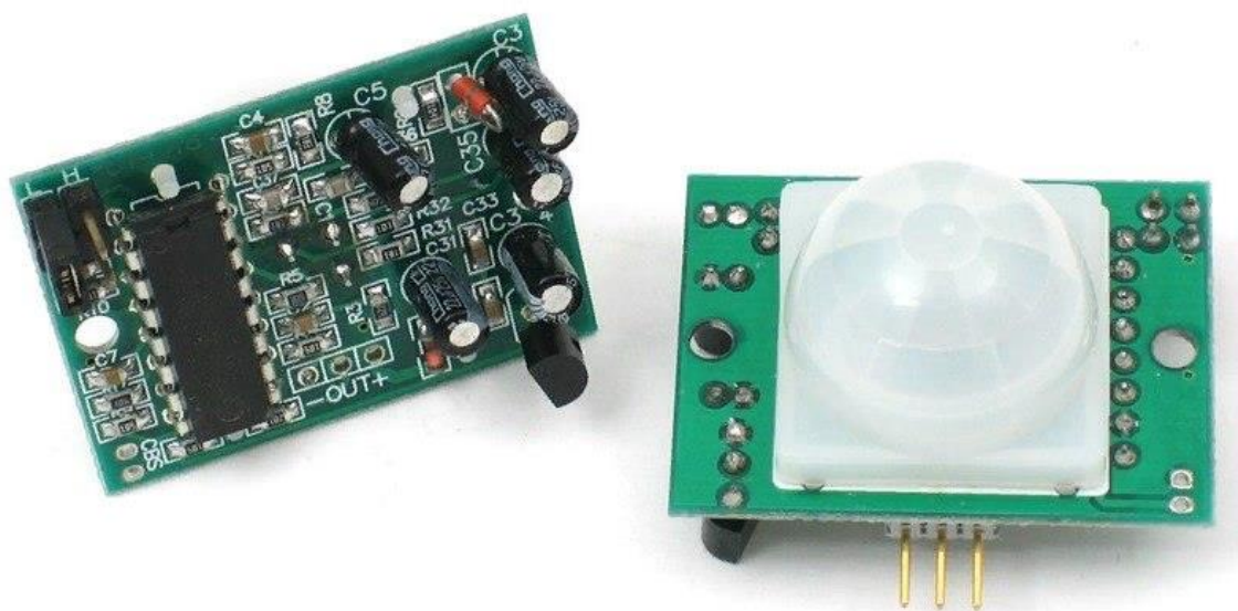
Рисунок 1.3 – Пасивний інфрачервоний PIR детектор
