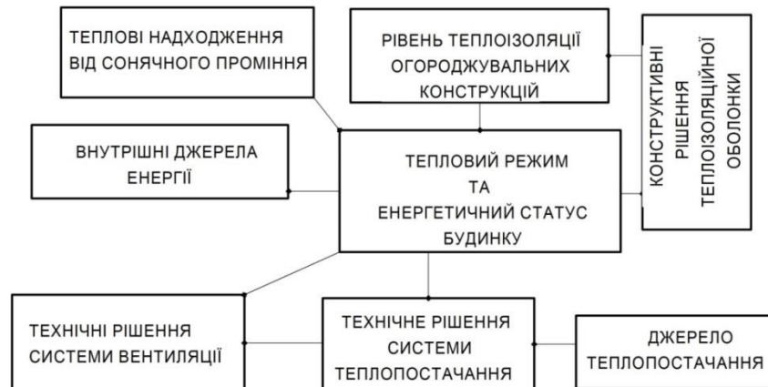
Рисунку 6 - Складові енергетичного балансу будівлі
