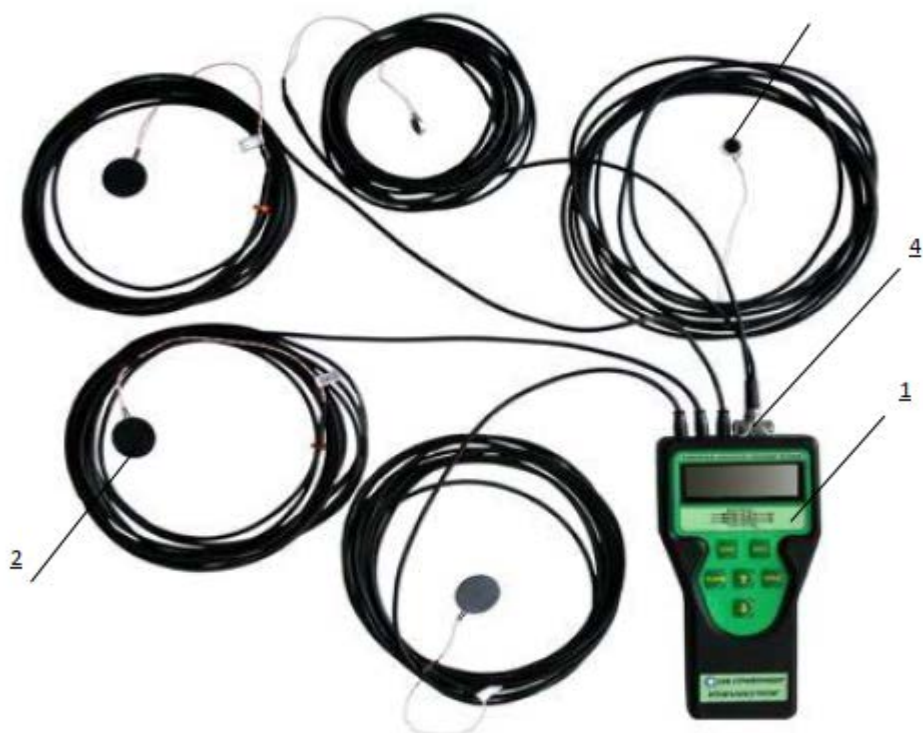
Рис. 2.2 – Зовнішній вигляд вимірювача щільності теплового потоку та температури ІТП-МГ4.03/5(ІІІ) «Потік»:
