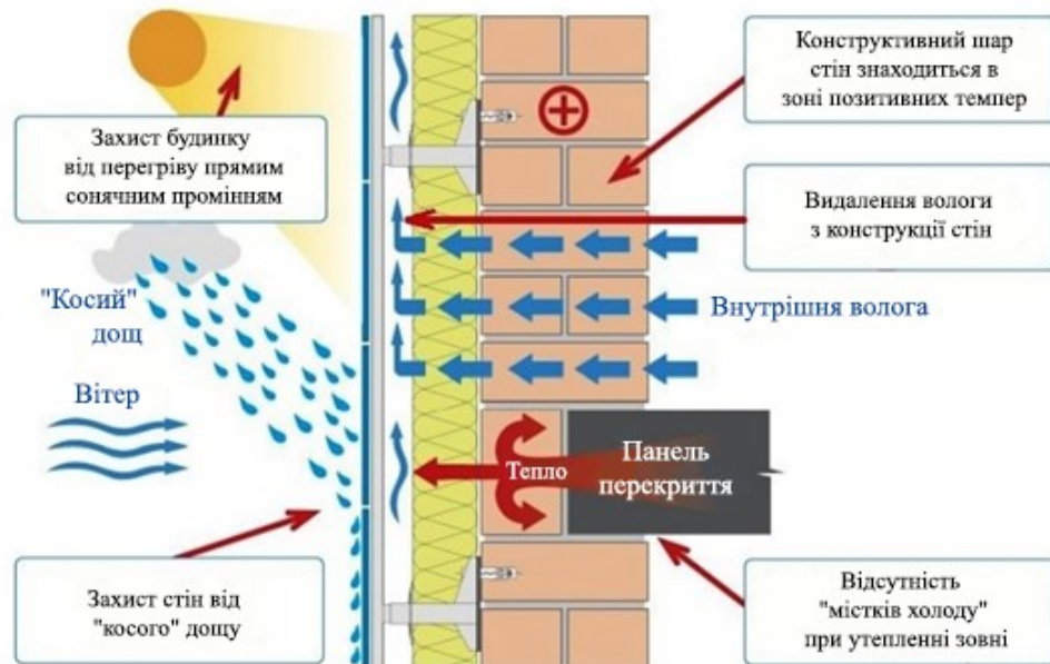
Рисунок 1.5 - Функціонування вентиляованого фасаду
