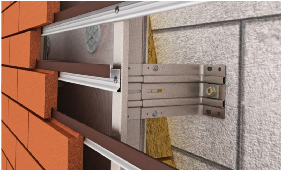
Рисунок 1.4 - Конструкція фасадної системи з вентиляльованим повітряним прошарком
