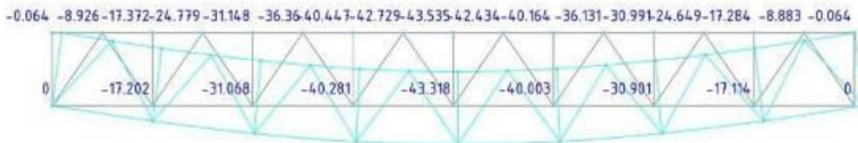
Рисунок 2.21 – Прогин ферми від експлуатаційних впливів з тимчасовим навантаженням А-15 (завантаження одним тандемом)
