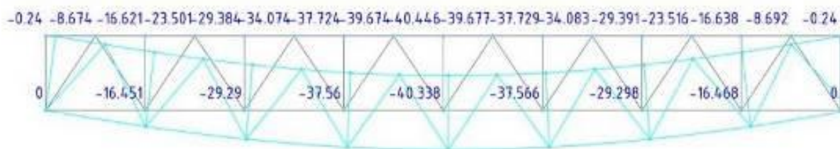
Рисунок 2.22 – Прогин ферми від експлуатаційних впливів з тимчасовим навантаженням А-15 (завантаження двома тандемами)
