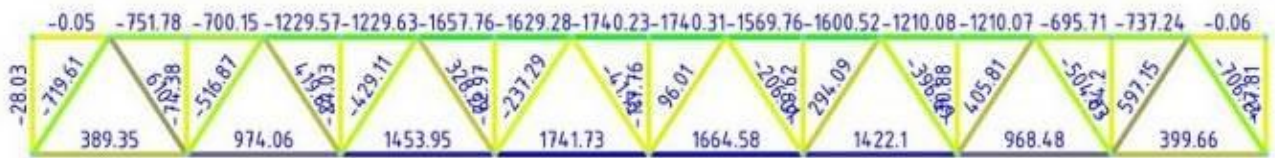
Рисунок 2.18 – Зусилля N, кН, що виникають в елементах ферми від завантажень постійними впливами + тимчасове навантаження (А-15, завантаження одним тандемом)
