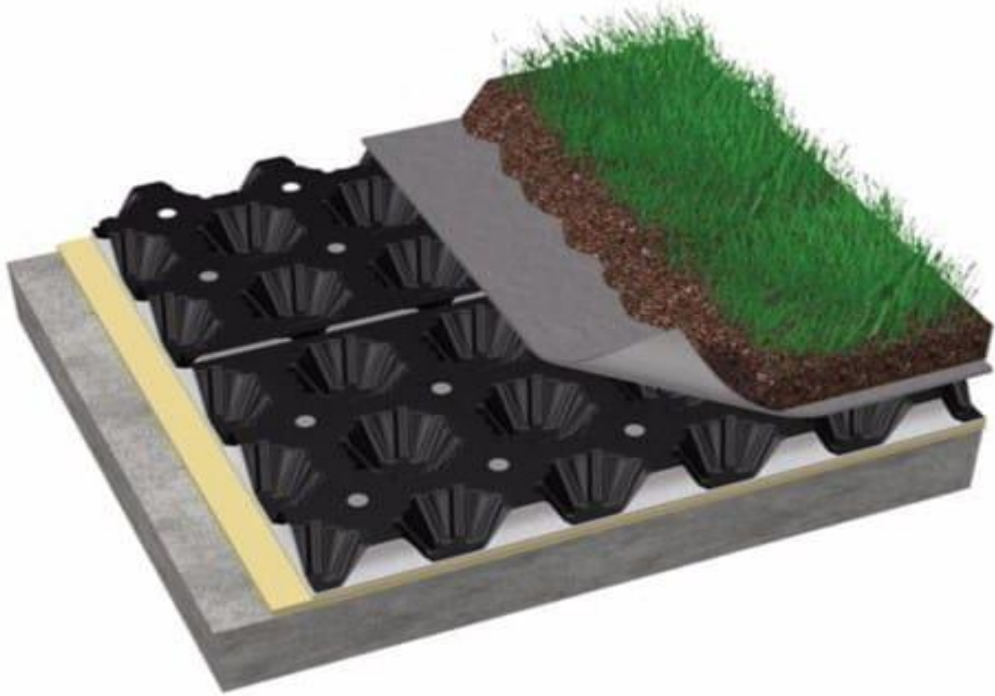
Рисунок 3.4 - Профільована мембрана з виступами DELTA-FLORAXX TOP
