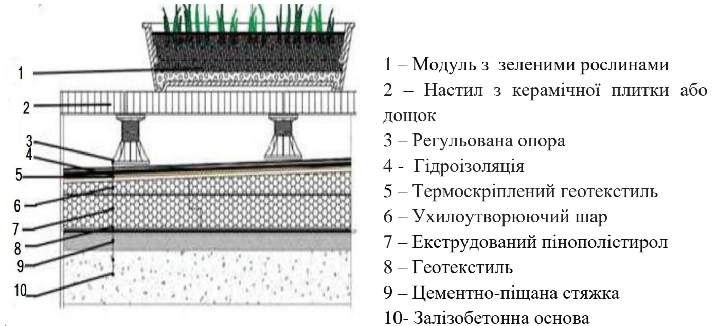
Рисунок 2.9 - Покрівля з застосуванням модульних конструкцій
