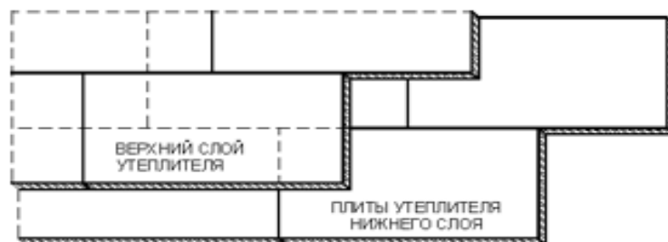
Зсув плит верхнього і нижнього шарів при укладанні.
