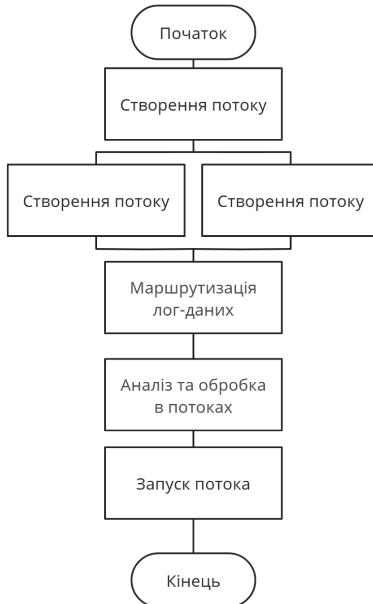
Рисунок 2.8 – Схема роботи механізму потоків лог-даних
