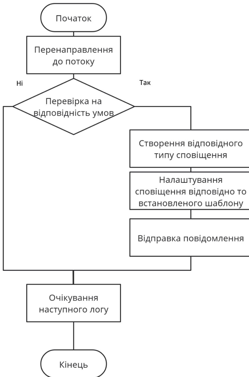
Рисунок 2.7 – Схема роботи системи сповіщень
