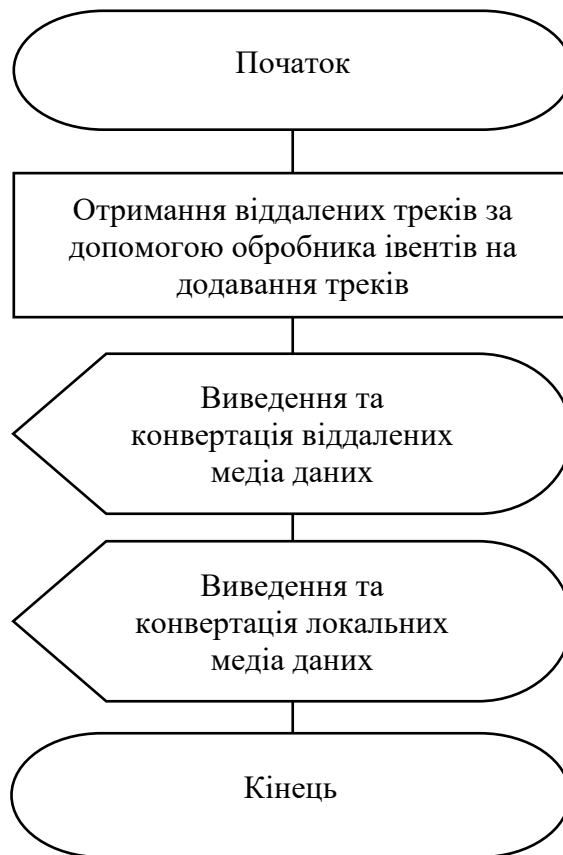
Рисунок 3.4 – Схема алгоритму роботи блоку отримання медіа даних
