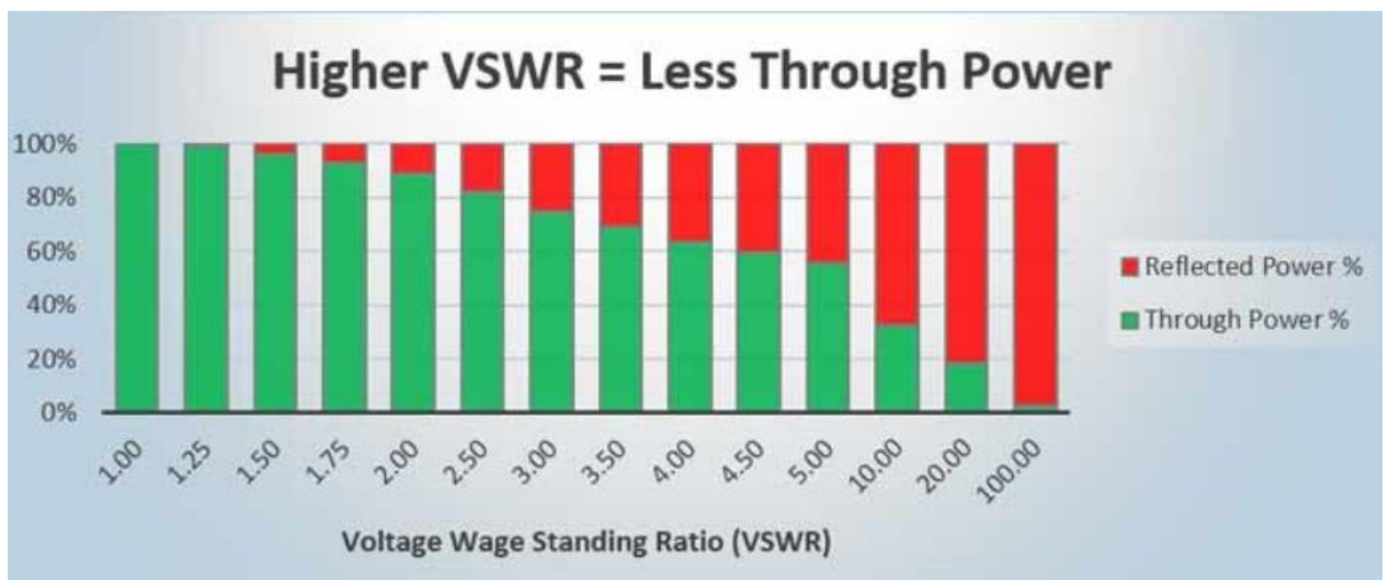
Рисунок 1.1 - КСХН як залежність від відбитої потужності
