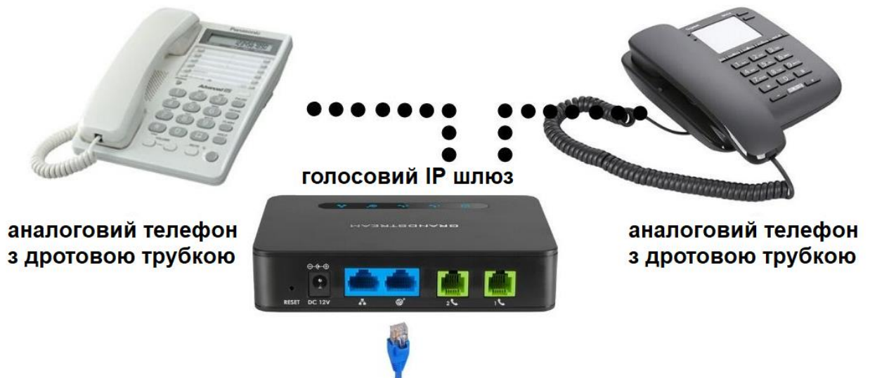
Рисунок 1.8 – Аналогові телефони з дротовою трубкою, що підключаються через голосовий IP-шлюз
