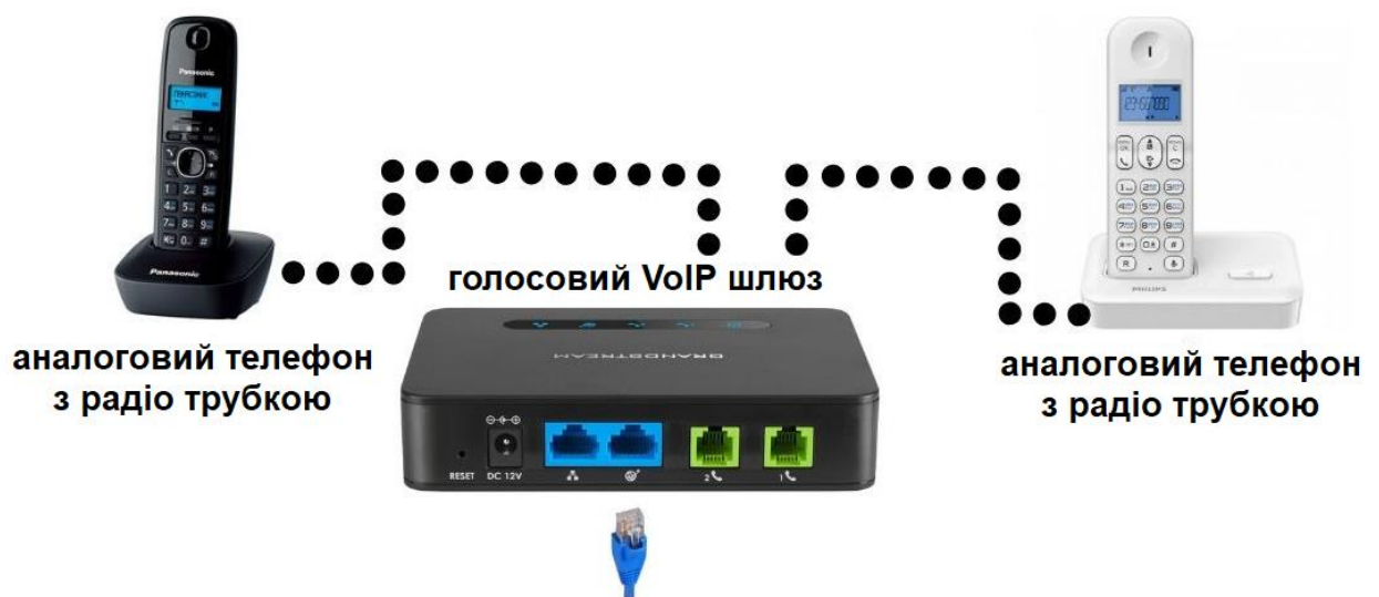
Рисунок 1.9 – Аналогові телефони з радіотрубкою, що підключаються через голосовий IP-шлюз
