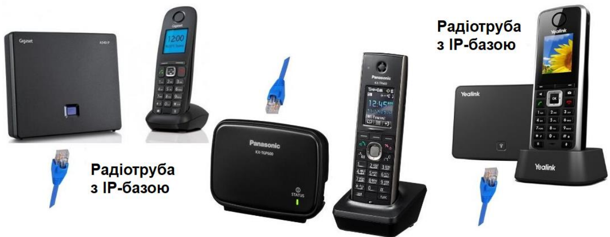
Рисунок 1.7 – IP-телефони з радіотрубою, прив'язаною до основної бази, яка підключається дротом до мережі
