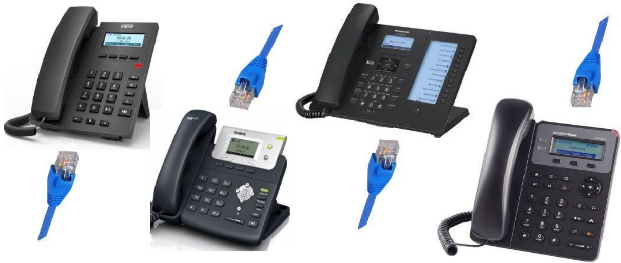
Рисунок 1.5 – IP-телефони з провідною трубкою та провідним підключенням до мережі
