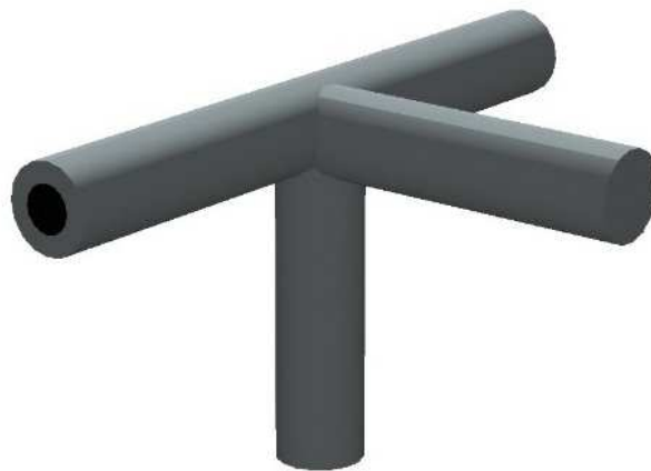
Рис 4.15 Муфтове кутове з'єднання, що пропонується (схематичне зображення 3D модель, авторс.)
