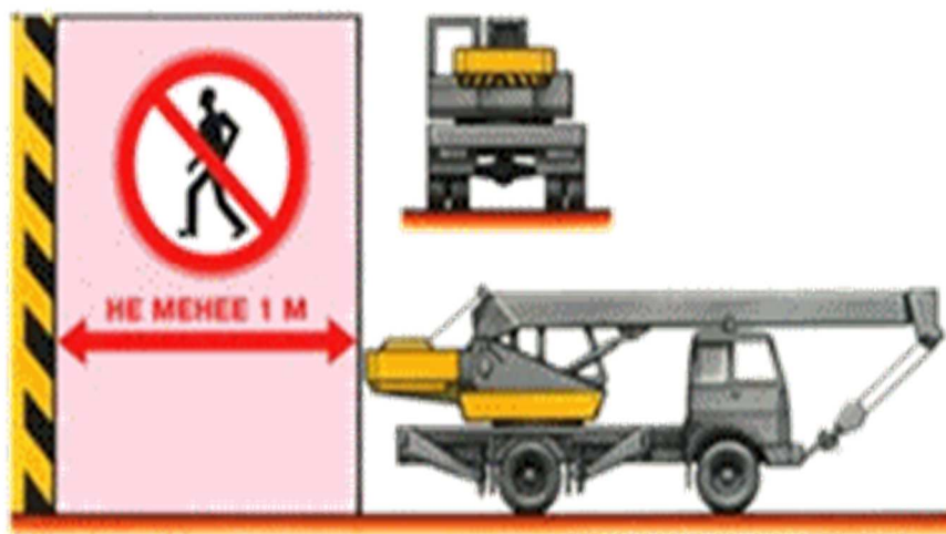
Рис. 6.2. Схема установки крана при наявності перепон.
