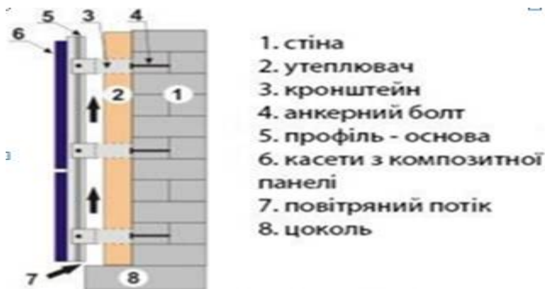
Рис. 4. 2 Принципова схема влаштування вентильційного фасаду.
