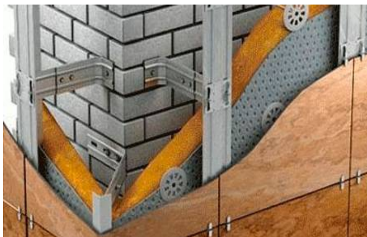
Рис. 4.10. Фрагмент найбільш поширеного навісного вентиляваного фасаду з використанням керамограніту.
