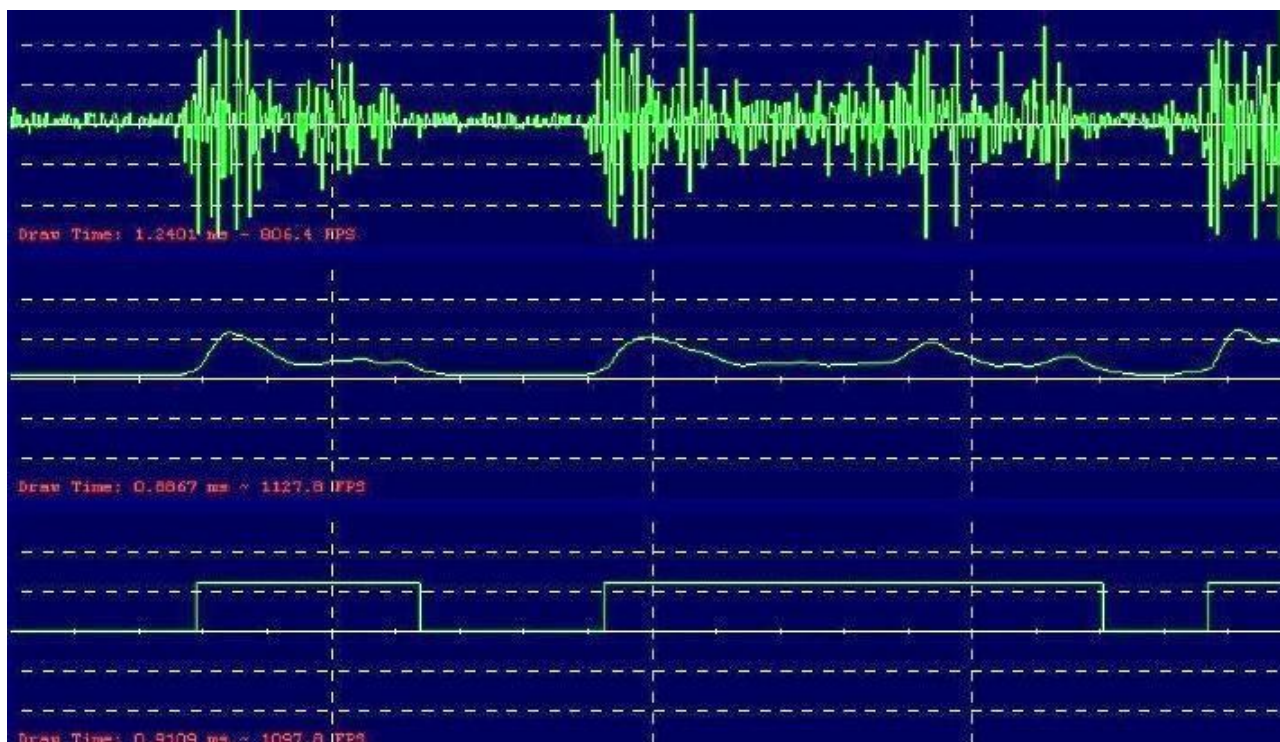
Рисунок 4.7 – Результати емуляції роботи модуля управління рухом біопротеза руки
