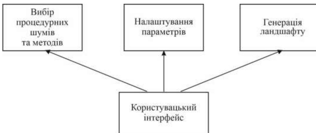
Рисунок В.2 – Структурна схема роботи інформаційної технології для генерації ландшафтів за допомогою процедурних шумів
