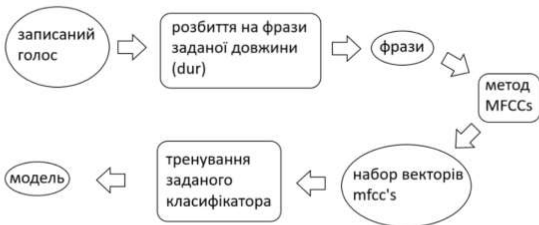
Рисунок 2.4 – Послідовність дій функціонування модулю обробки даних
