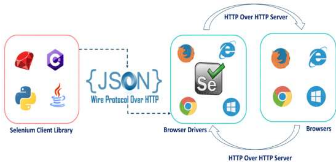
Рисунок Г.3 – Принцип роботи Selenium Webdriver
