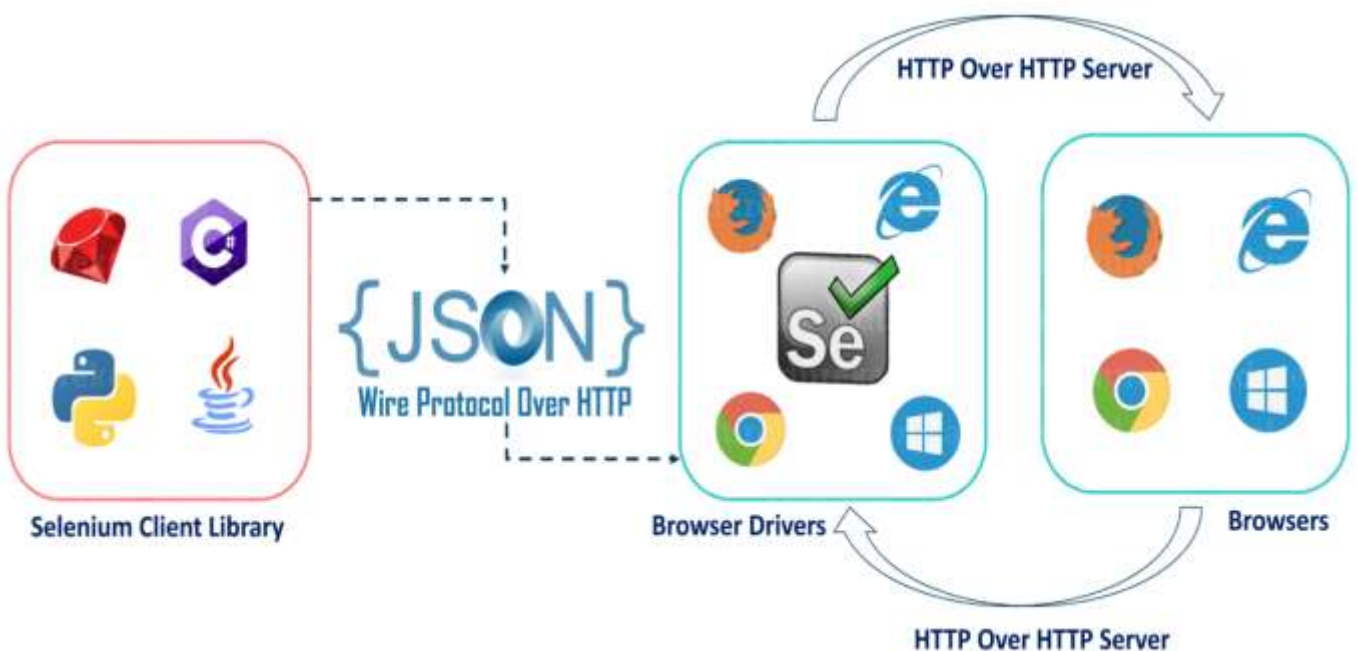
Рисунок 1.1 – Принцип роботи Selenium Webdriver
