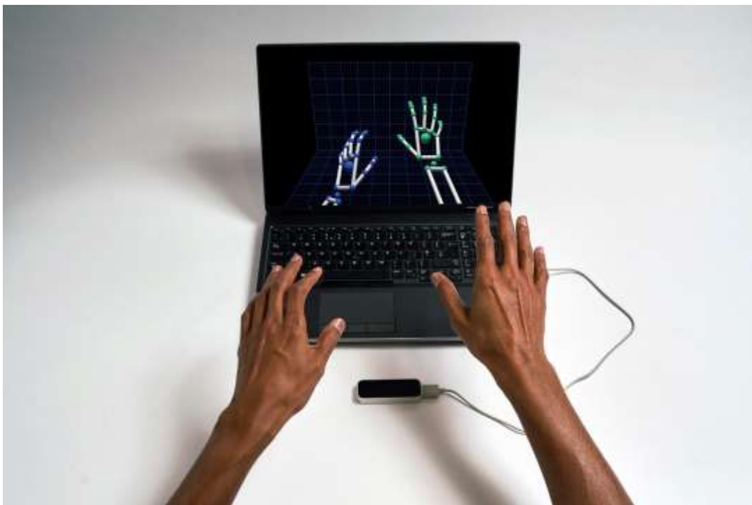
Рисунок 1.1 – Периферійний пристрій візуального розпізнавання жестів
