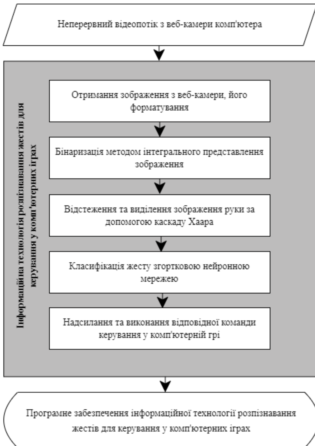
Рисунок 3.1 – Загальна структурна схема функціонування інформаційної системи розпізнавання жестів для керування у комп'ютерних іграх
