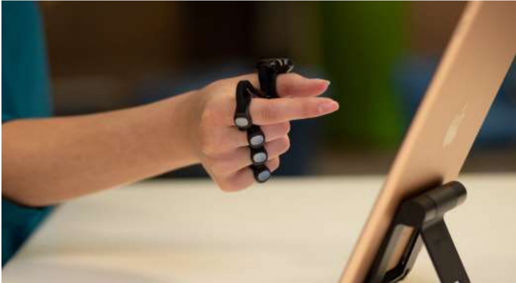
Рисунок 1.9 – Периферійний пристрій визначення відстані та напрямку руки
