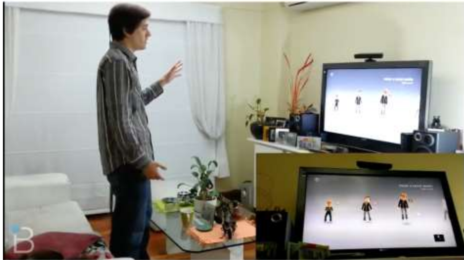
Рисунок 1.5 – Периферійний пристрій відстеження рухів з використанням камери та інфрачервоного датчика для керування у ком’ютерних іграх
