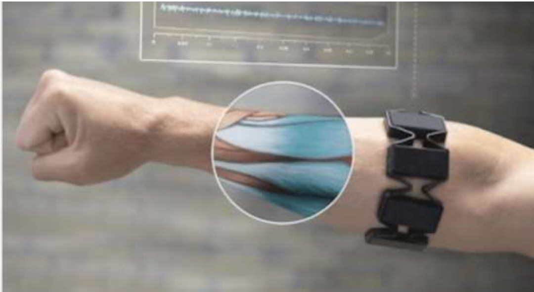
Рисунок 1.2 – Периферійний пристрій відстеження м'язової активності
