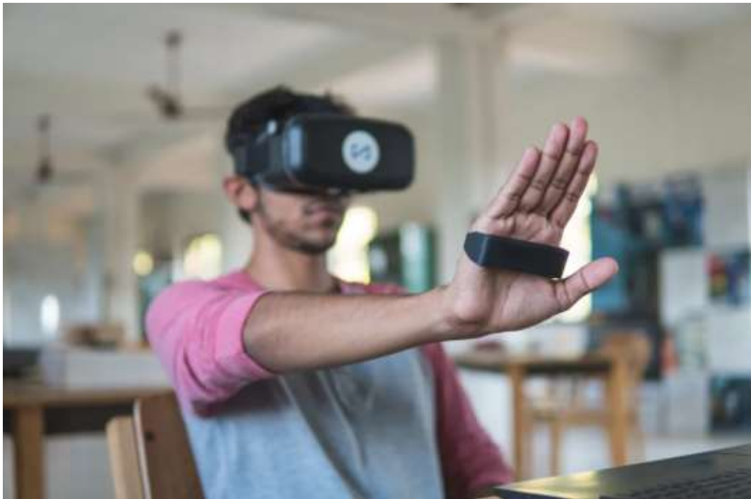
Рисунок 1.6 – Периферійний пристрій розпізнавання жестів з відстеженням окремих пальців
