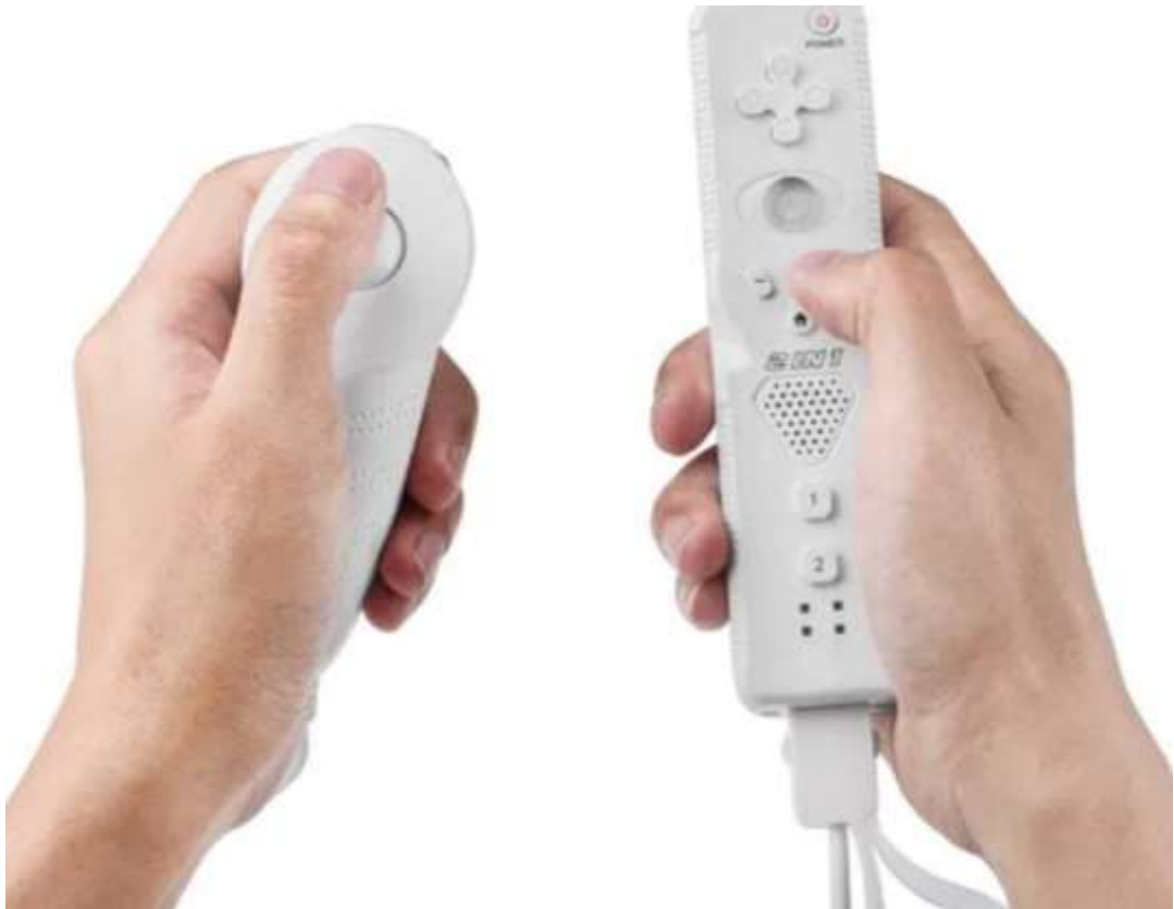
Рисунок 1.3 – Периферійний пристрій відстеження рухів з використанням контролера для керування ігровою приставкою
