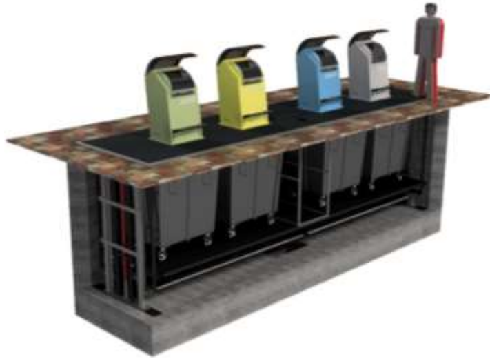
Рисунок 1.1 – Підземний контейнерний майданчик з датчиками наповненості сміття
