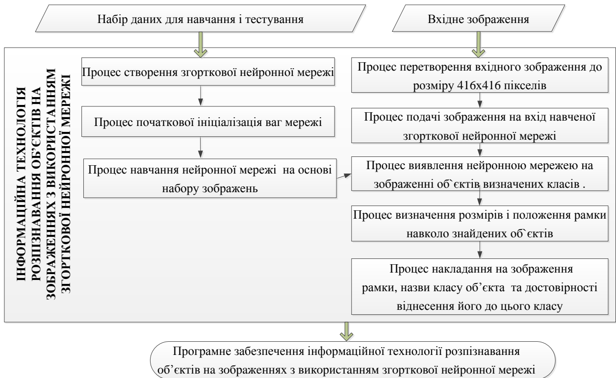
Рисунок 2.9 - Структура інформаційної технології розпізнавання об'єктів на зображеннях з використанням згорткової нейронної мережі
