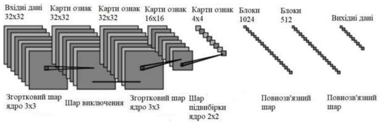
Рисунок В.1 – Архітектура запропонованої згорткової нейронної мережі, що спроектована на основі SSD архітектури.
