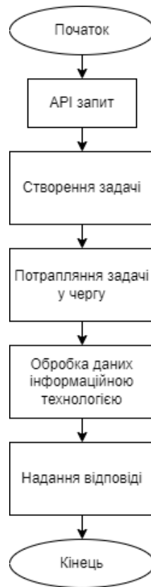
Рисунок 4.3 – Загальна схема алгоритму роботи інформаційної технології для виявлення HTTP запитів з аномальною поведінкою
