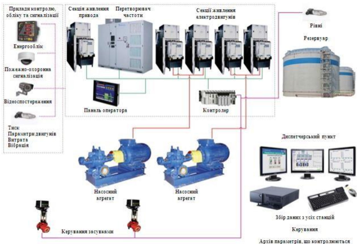
Рисунок 2.2 – Схема автоматизації насосних агрегатів з перетворювачем частоти
