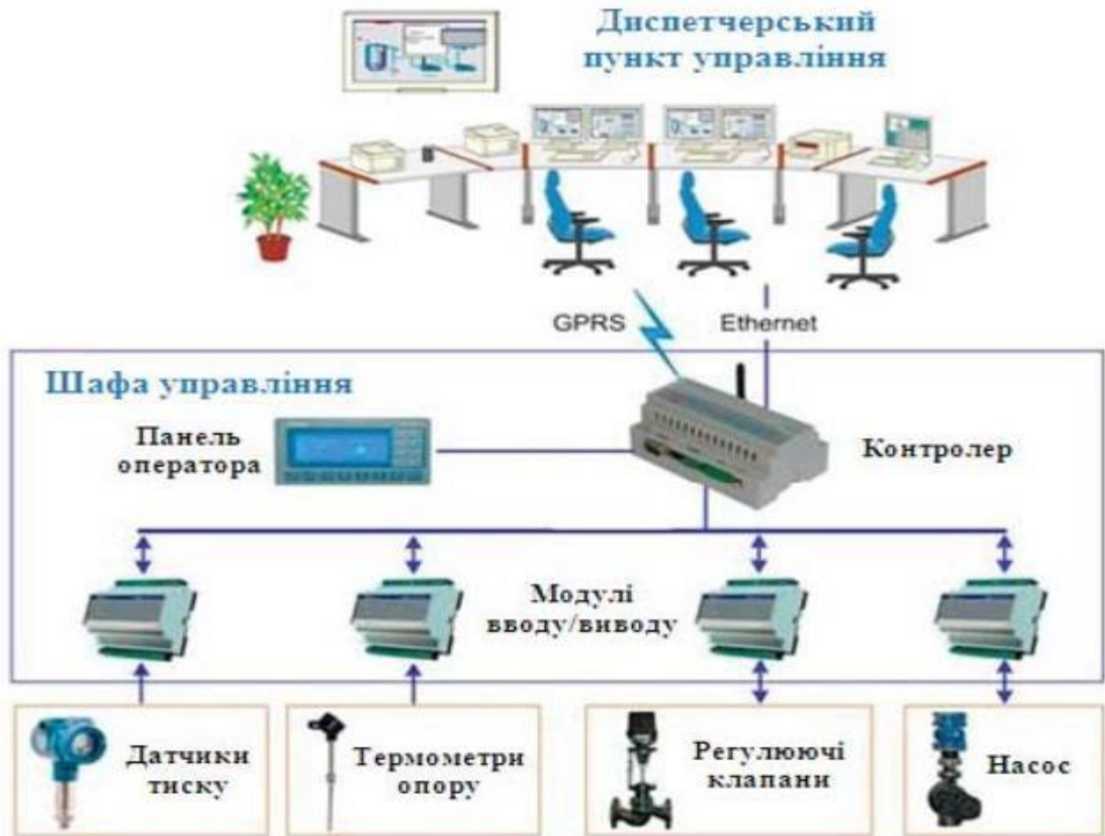
Рисунок 2.1 – Схема роботи АСУ ТП мережевим насосом
