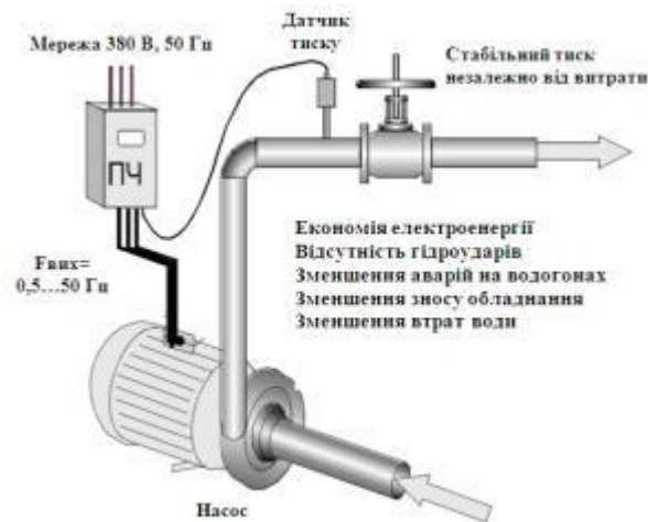
Рисунок 2.3 – Принципова схема включення перетворювача частоти до насосної установки
